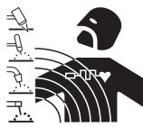
A corrente eléctrica que atravessa qualquer condutor produz campos electromagnéticos (EMF). A corrente de soldadura, ou de corte, gera campos electromagnéticos em redor dos cabos e dos geradores.
