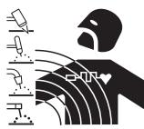
• Le courant électrique traversant n'importe quel conducteur produit des champs électromagnétiques (EMF). Le courant de soudure ou de découpe produisent des champs électromagnétiques autour des câbles ou des générateurs.
