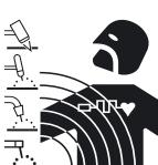
· Aina kun sähkö kulkee johtimen läpi muodostuu johtimen ympärille paikallinen sähkö- ja magneettikenttä EMF. Hitsaus-/ leikkausvirta synnyttää EMF -kentän kaapelien ja virtalähteen ympärille.
