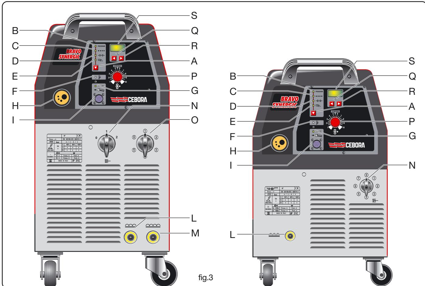
när svetsbrännaren i standardutförandet används och inte vid användning av svetsbrännaren PULL 2003 eller SPOOL-GUN. När programmet 00 används varierar svetsstrådens hastighet mellan 0 och 20 meter/minut.
