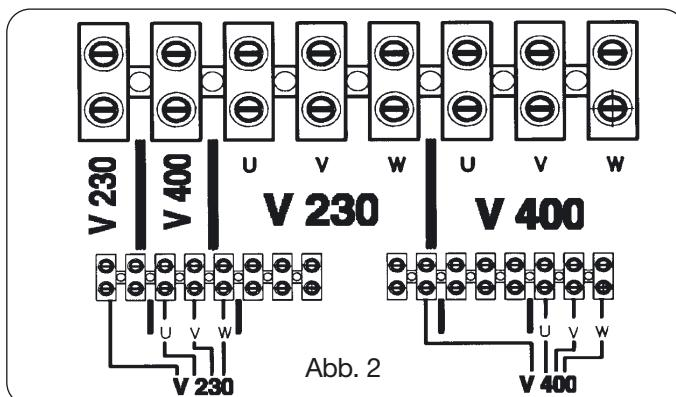
Bei den einphasigen Stromquellen kann die Versorgungsspannung nicht geändert werden.
